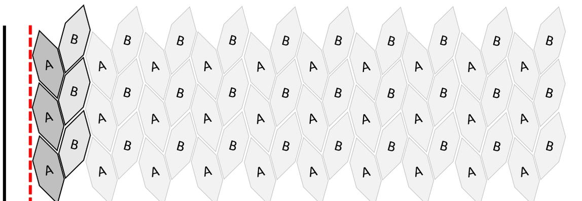
1. Se marca una línea en la pared y todas las piezas A lindan con esta línea en uno de los puntos, después colocar las piezas B.
