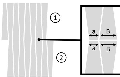
**¡IMPORTANTE!** Las mallas PLAGE deben colocarse siguiendo la indicación del dibujo anterior para dar una correcta continuidad al patrón geométrico.
