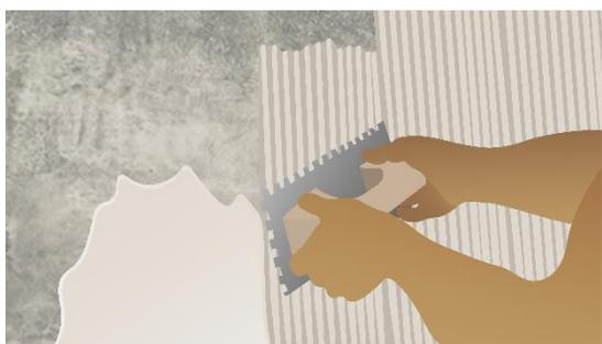
3. Aplicar una capa de cemento cola en la pared.
