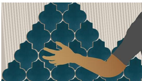
5. Colocar los azulejos, siendo la junta alrededor de 3 a 4 mm y variando según piezas ya que al estar fabricadas de forma artesanal, las dimensiones varían entre piezas.
